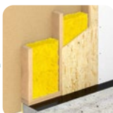
Dämmung in Holzrahmen-Konstruktionen
